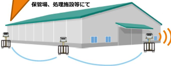
通信回線、ルータ等を使用することで最大10台のモニターを1台のPCで遠隔監視することができます。
