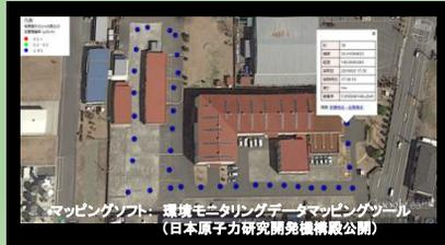
歩行モニタリングによる線量率分布図作成事例
